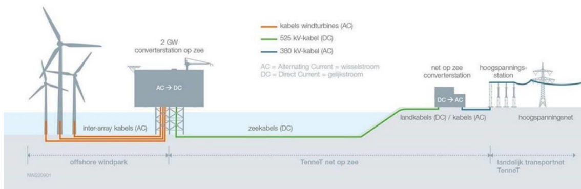
Figuur 2.2 Onderdelen elektrische verbinding gelijkstroom (DC)
